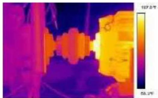
L'ispezione termografica può consentire di rilevare anche anomalie nei sistemi meccanici: sbilanciamenti e usure eccessive determinano, infatti, un surriscaldamento dei componenti meccanici, con conseguente funzionamento meno efficiente che, se non rilevato, può portare alla rottura.
