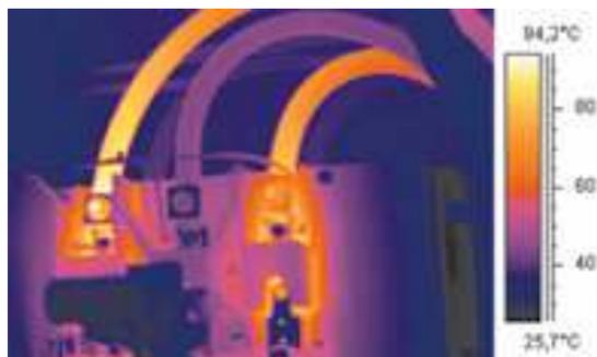
In particolare, tramite l'analisi di immagini termiche, è possibile individuare connessioni ad alta resistenza, collegamenti corrosi, danni a fusibili, guasti a componenti elettrici.
